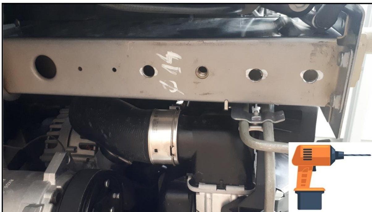
Powiększenie otworu na Ø14 od spodu w prowadnicach samochodu. Zabezpieczyć podkładem przed korozją. Enlarging the hole for Ø14 from below in the guides of the car. Protect against corrosion with primer.
