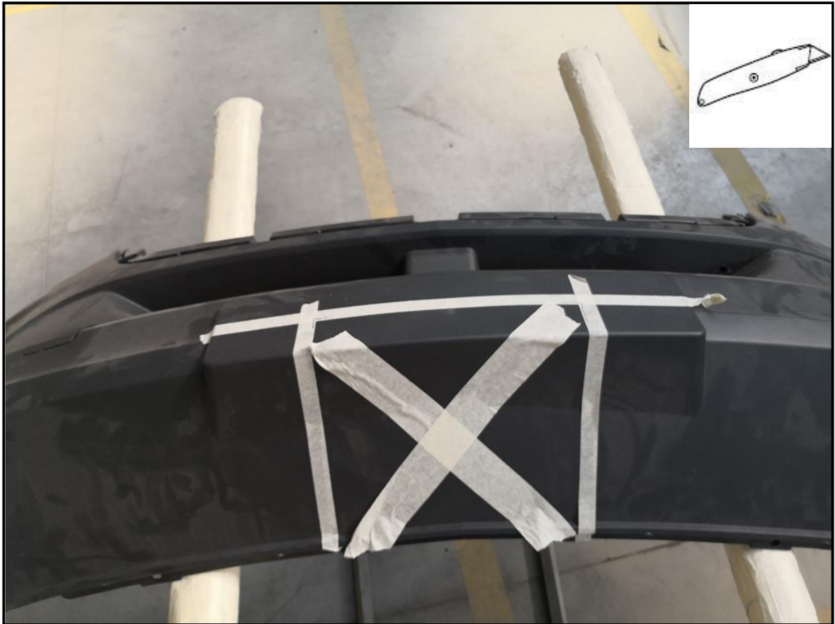
Wycinanie plastiku w dolnym zderzaku. Zabezpieczenie krawędzi kebrą. Cutting out plastic in the lower bumper. Edge protection with rubber,
