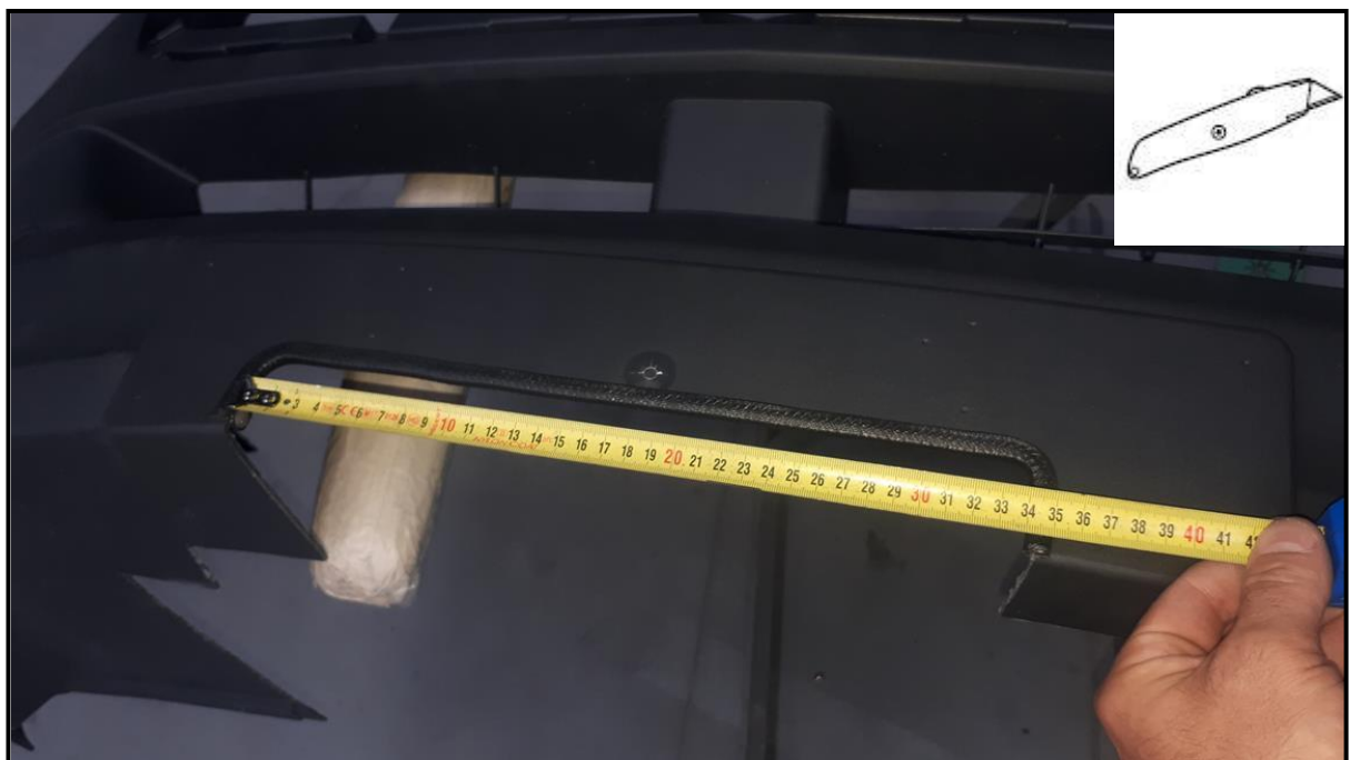
Wycinanie plastiku w dolnym zderzaku. Zabezpieczenie krawędzi kebrą. Cutting out plastic in the lower bumper. Edge protection with rubber,
