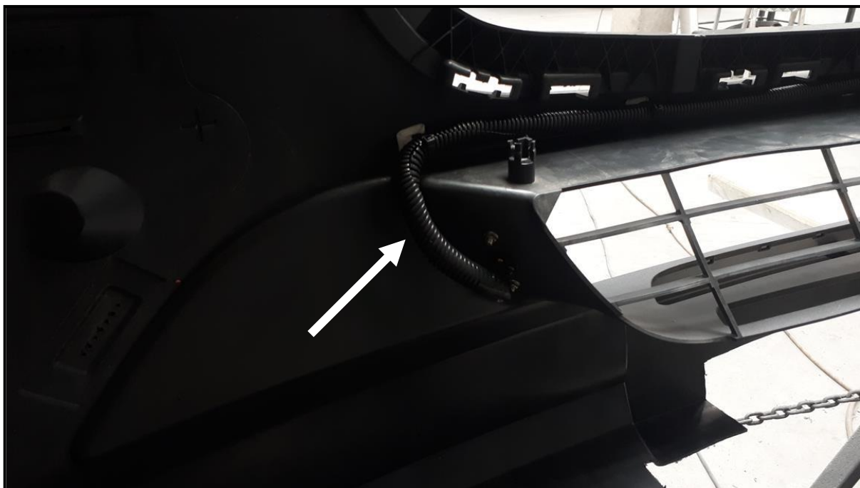
Poprowadzenie przewodu od pilota do przekaźnika. Cable routing from the remote control to the relay.
